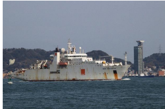
巖流島からのシップウォッチング。世界最大級の海底ケーブル敷設船 Rene Descartes。太平洋を横断する8000kmのケーブル敷設を行った船です。
